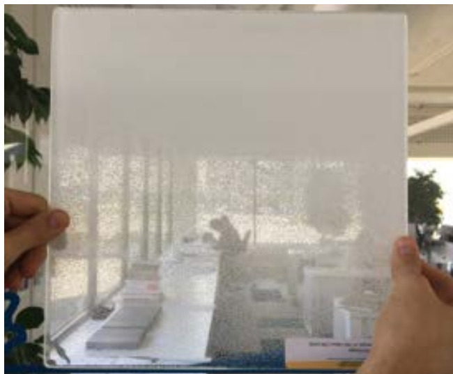
Figure 6.7 Occultation solaire par sérigraphie
